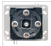
Bild 2: Ansicht von unten. Hier ist die diagonale Bewegungsrichtung erlaubt. Die Stellung der Scheibe (mittige Aussparung) erlaubt das diagonale Ausschlagen der Achse.
