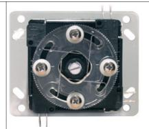
Bild 3: Ansicht von unten. Hier ist die diagonale Bewegungsrichtung NICHT erlaubt. Die Stellung der Scheibe (mittige Aussparung) verhindert eine diagonale Bewegung der Achse.
